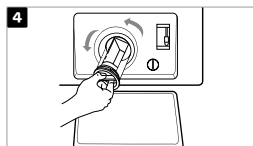
4 Open het pompfilter door het linksom te draaien. Reinig het pompfilter onder een lopende kraan.
