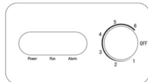
En cas de hausse de la température ambiante, réglez l'appareil sur une position plus élevée pour pouvoir assurer la même température intérieure.
