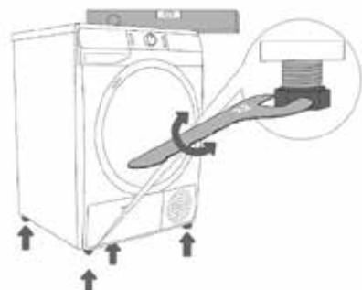
1. Drehen Sie die verstellbaren Füße mit einem Maulschlüssel hinein oder heraus.
