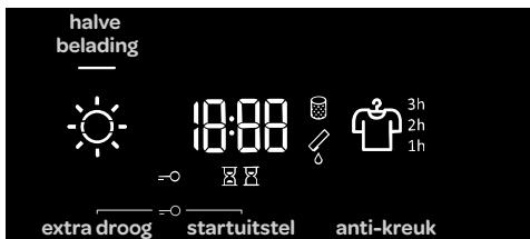
Lorsque le délai prédéfini expire, le programme de séchage sélectionné démarre automatiquement.
