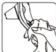
Setzen Sie das Thermometer nach dem Reinigen in den mitgelieferten Halter. Bewahren Sie das Thermometer in einem sauberen, trockenen Raum bei Zimmertemperatur auf. Setzen Sie das Thermometer nicht extremen Temperaturen, Feuchtigkeit, direktem Sonnenlicht oder Erschütterungen aus.
