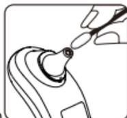
Verwenden Sie ein weiches Tuch, um das restliche Thermometer zu reinigen.
