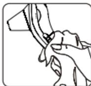
Après nettoyage, placez le thermomètre dans le support fourni. Conservez le thermomètre dans un endroit propre et sec, à température ambiante. N'exposez pas le thermomètre à des températures extrêmes, à l'humidité, à la lumière directe du soleil ou à des chocs.
