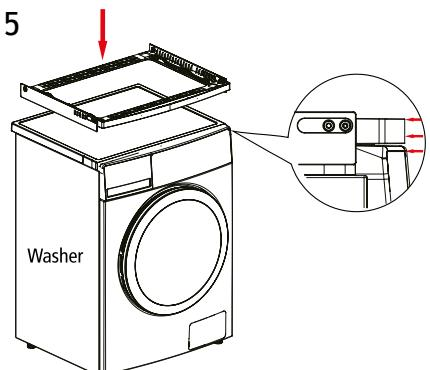
Opmerking: lijn de beugel B en de wasmachine uit voordat u de beugel B vastplakt met de stickers onderop de beugel.
