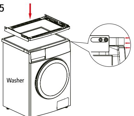
Remarque : Alignez le support B et la machine à laver avant de coller le support B avec les autocollants au bas du support.
