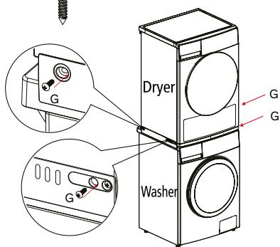
Si la base du sèche-linge n'est pas en métal, serrez les quatre vis G à l'avant et à l'arrière.
