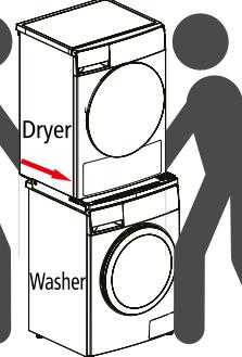
Placez le sèche-linge à l'arrière de la partie supérieure du lave-linge, puis poussez le sèche-linge vers l'avant jusqu'à ce que les trous s'alignent.
