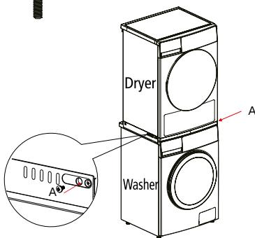
Wenn die Unterseite des Trockners aus Metall besteht, ziehen Sie nur die vorderen zwei Schrauben A fest.
