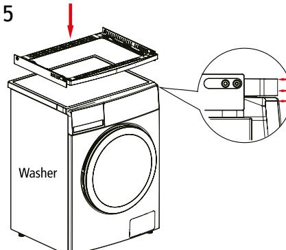
Hinweis: Richten Sie die Halterung B und die Waschmaschine aus, bevor Sie die Halterung B mit den Aufklebern an der Unterseite der Halterung anbringen.
