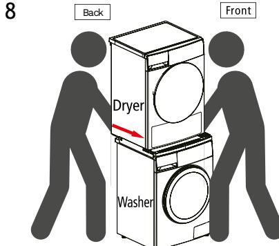
Stellen Sie den Trockner hinten auf die Oberseite der Waschmaschine und schieben Sie ihn nach vorne, bis die Öffnungen miteinander ausgerichtet sind.
