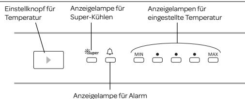
Die Standardtemperatur des Kühlgeräts ist auf einen mittleren Wert eingestellt.
