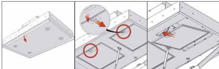
Controleer of de stekker uit het stopcontact is verwijderd. Open het onderste deel van de afzuigkap door deze voorzichtig naar beneden te trekken.
